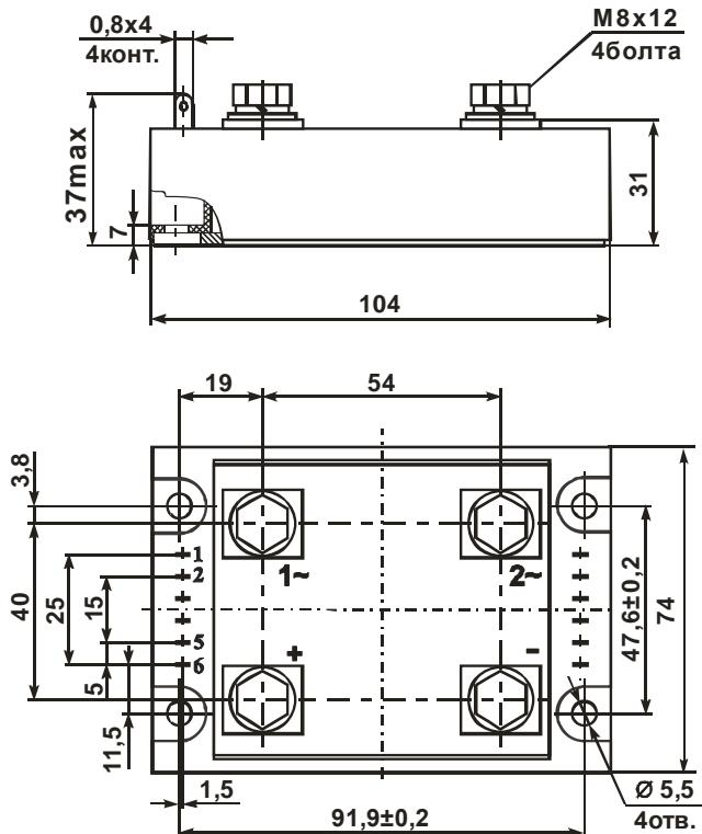
Неуказанные отклонения присоединительных размеров  $\pm 0,5\text{мм}$
