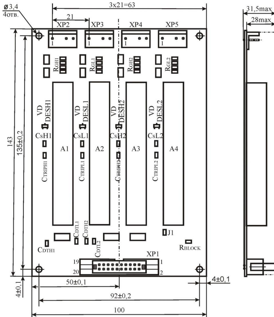
Рисунок 1 – Габаритный чертеж драйвера
