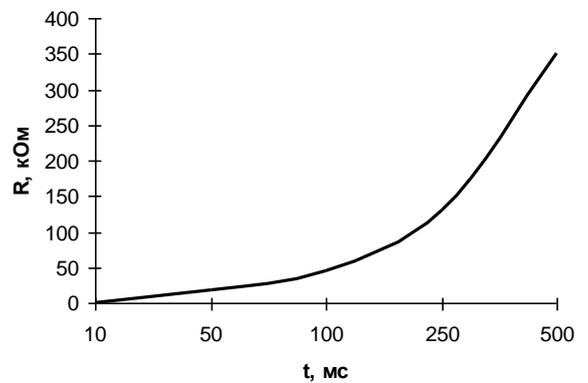
Рисунок 8 – График зависимости длительности блокировки схемы управления после аварии от номинала сопротивления  $R_{block}$
