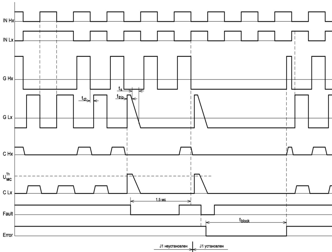
Рисунок 4 – Функциональная диаграмма работы драйвера при «аварии»
