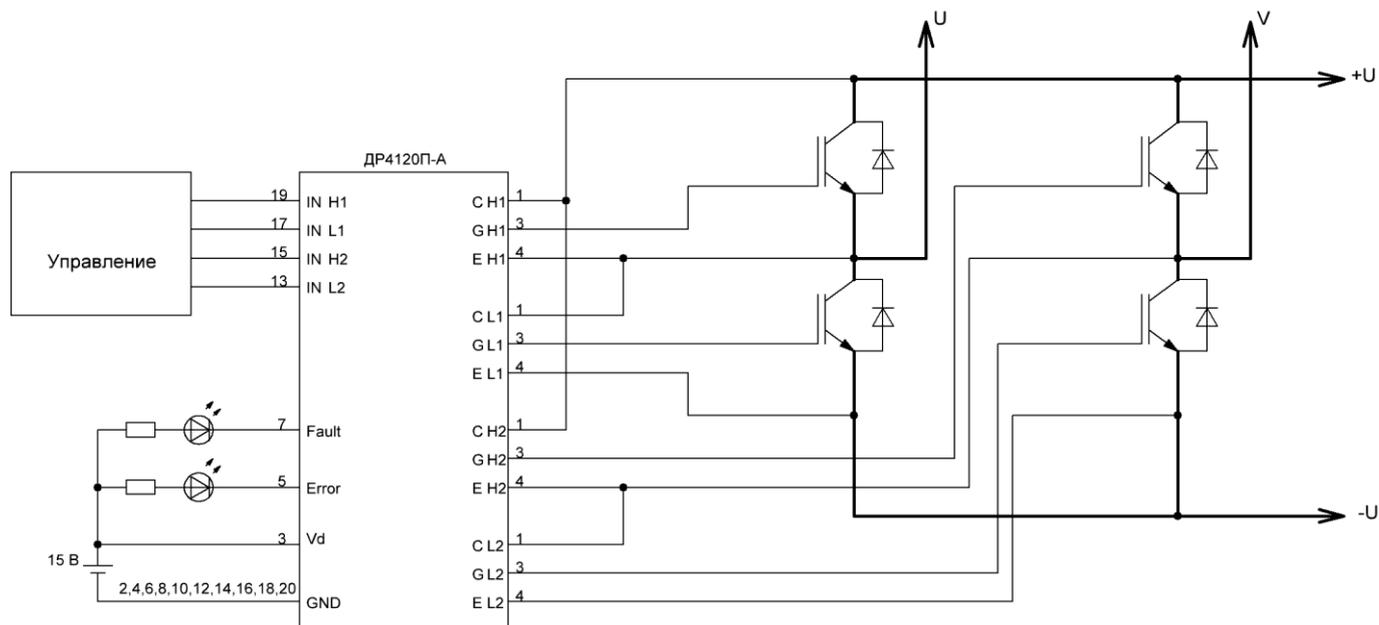
Рисунок 3 – Схема включения драйвера
