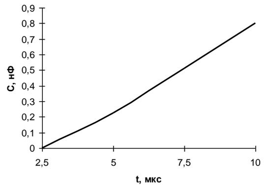
Рисунок 6 – График зависимости длительности задержки срабатывания защиты по ненасыщению от номинала ёмкости  $C_{TRIP}$
