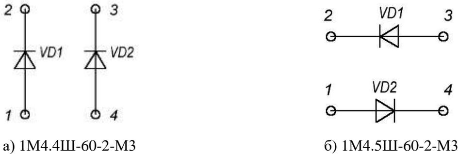
Рисунок 1 – Структурная схема модуля
