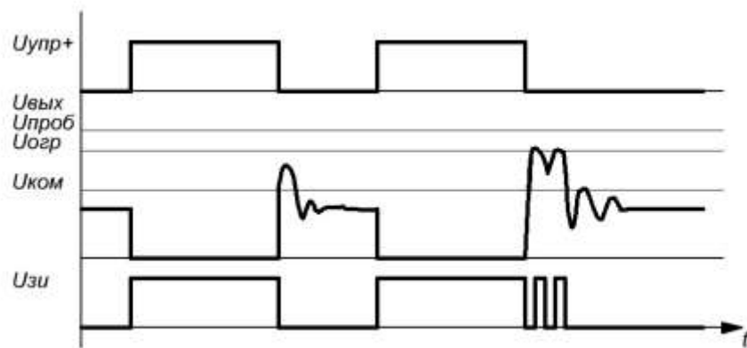
Рисунок 1.9 — Функционирование активной защиты ограничения напряжения
