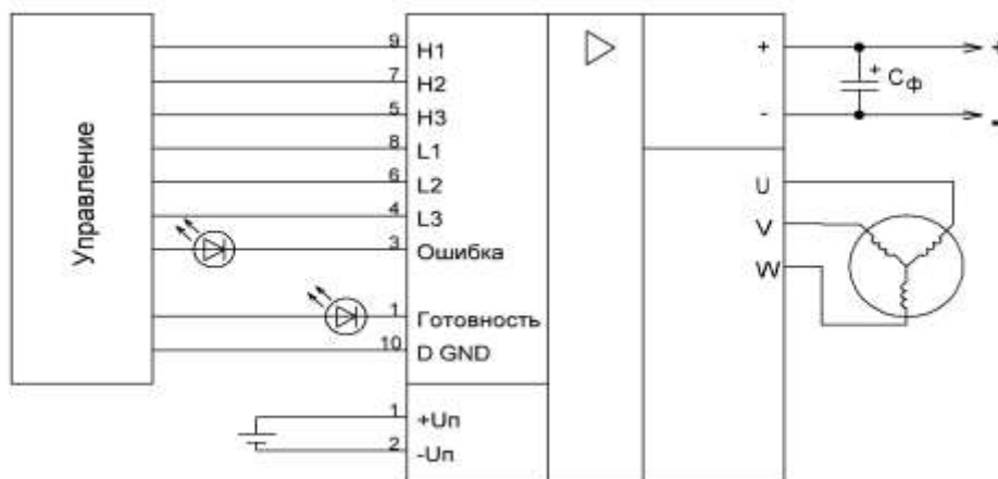
где C_{\phi} – ёмкость фильтра Рисунок 3.4 – Схема включения 1МИ
