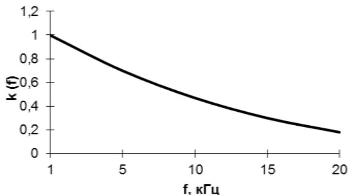
Рисунок 6.2 – Поправочный коэффициент  $k_F$  тока от частоты
