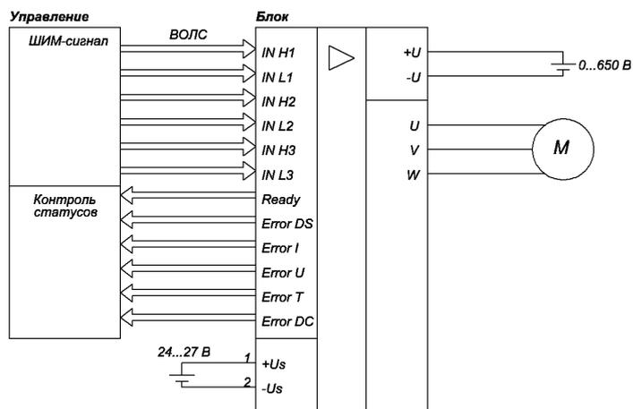
Рисунок 3.3 – Типовая схема включения Б31-500-12АВ
