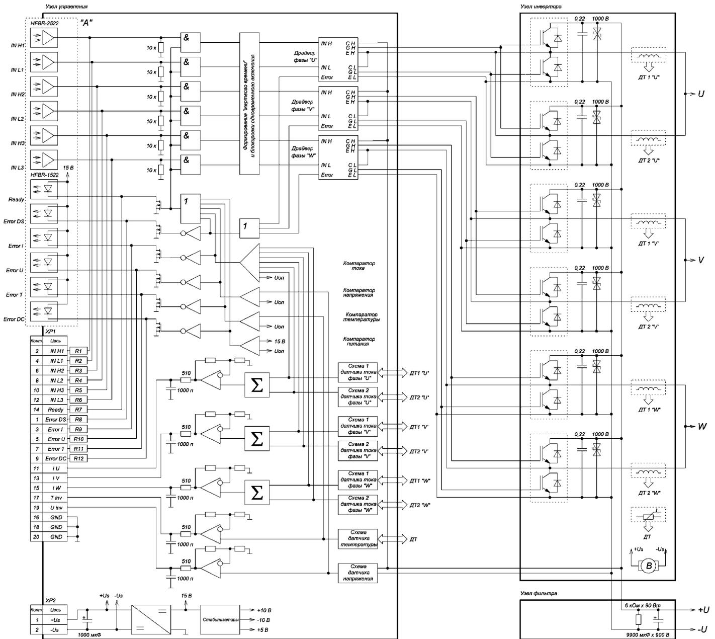
Где «А» - узел волоконно-оптического управления устанавливаемый только для Б31-500-12АВ,
