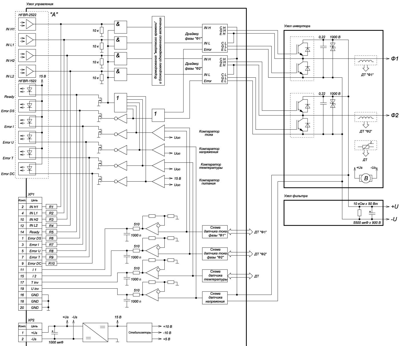
Где «А» - узел волоконно-оптического управления устанавливаемый только для Б31-300-12БВ, R1...R10 – перемычки SMD, устанавливаемые только для Б31-300-12БП
