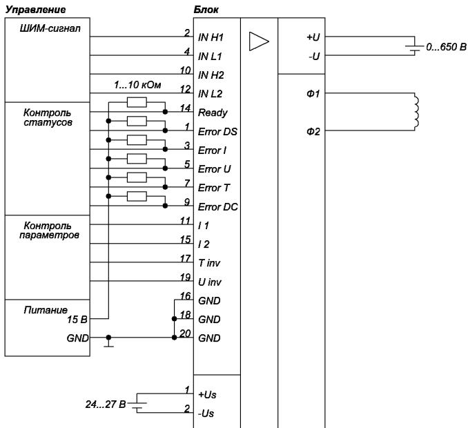
Рисунок 3.2 – Типовая схема включения
