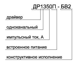
Рисунок 1 – Структура обозначения драйвера
