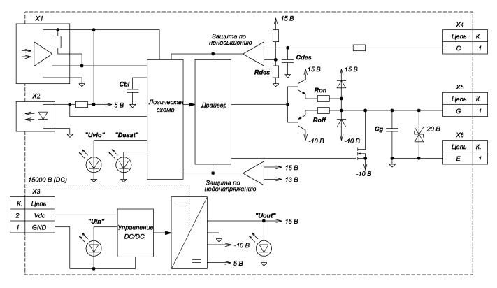
Рисунок 3- Функциональная схема драйвера
