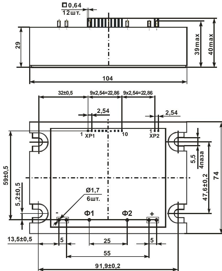
Неуказанные предельные отклонения присоединительных размеров  $\pm 0,2$  мм
