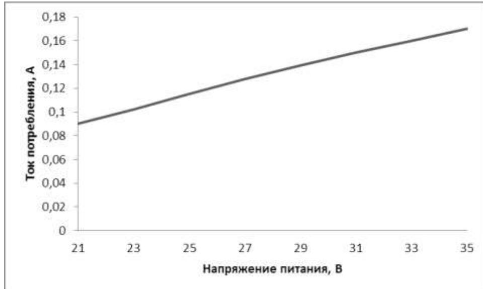
Рисунок 5.2 – Типовая зависимость тока потребления от напряжения питания
