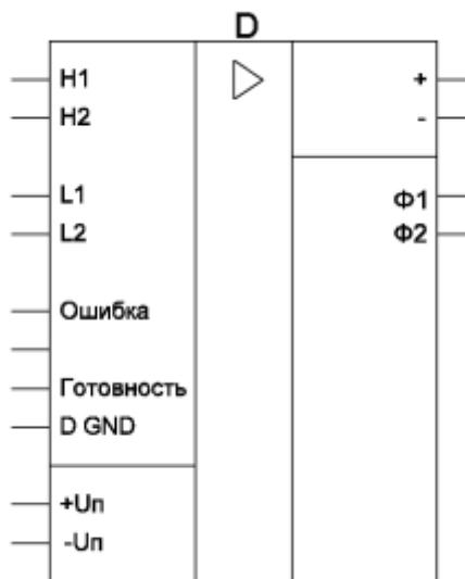
Рисунок 3.3 – Условно-графическое обозначение 5МИ
