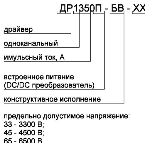
Рисунок 1 – Структура обозначения драйвера
