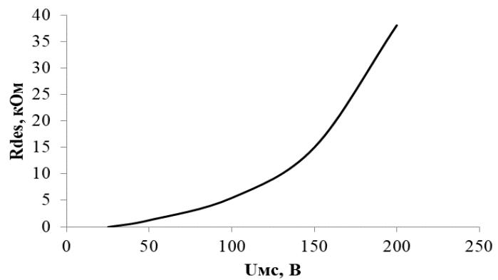
Рисунок 10 – График зависимости напряжения срабатывания защиты по насыщению от номинала резистора  $R_{des}$
