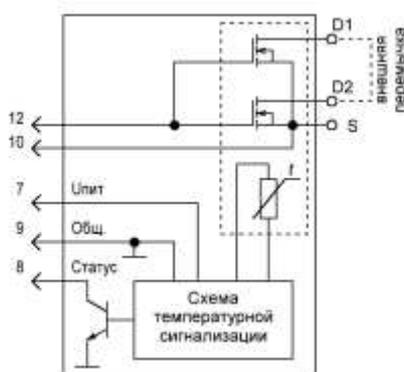
Рисунок 1 – Электрическая схема соединения элементов модуля
