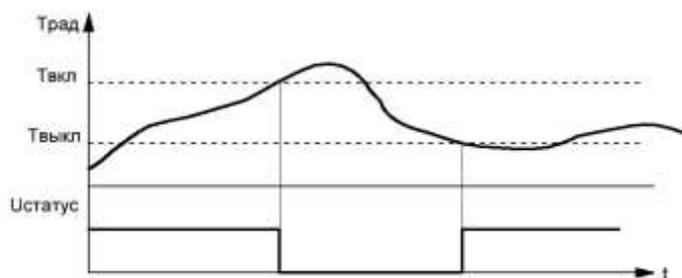
Рисунок 3 – Диаграмма функционирования температурной сигнализации
