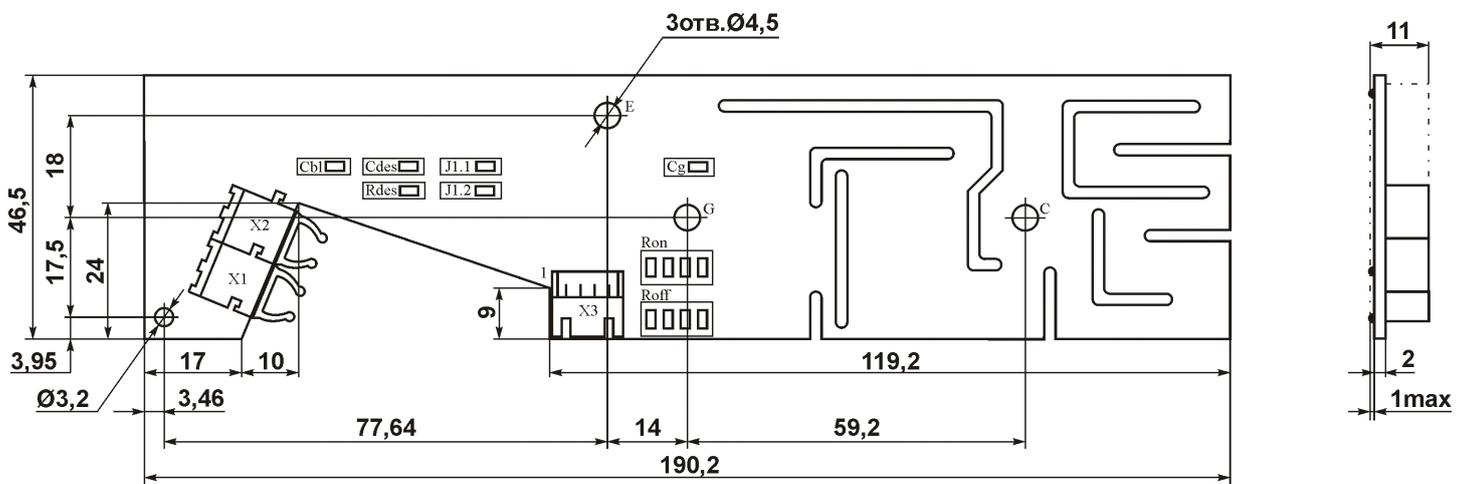
Рисунок 2 – Габаритный чертеж драйвера ДР1350-В4-1-хх
