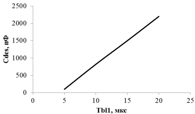
Рисунок 11 – График зависимости длительности задержки включения защиты по насыщению от номинала ёмкости  $Cdes$
