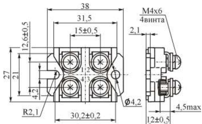
Рисунок 2 – Габаритные и присоединительные размеры
