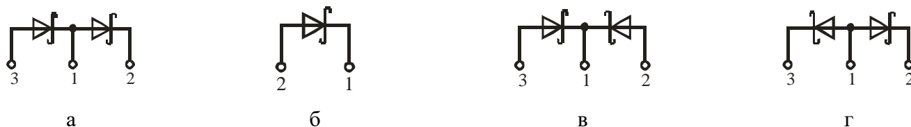
Рисунок 1 – Схема соединения модуля
