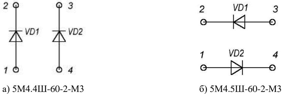
Рисунок 1 – Структурная схема модуля
