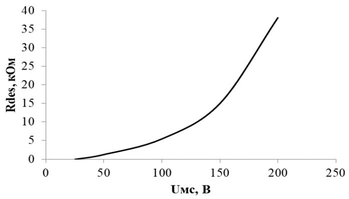
Рисунок 9 – График зависимости напряжения срабатывания защиты по насыщению от номинала резистора  $R_{des}$
