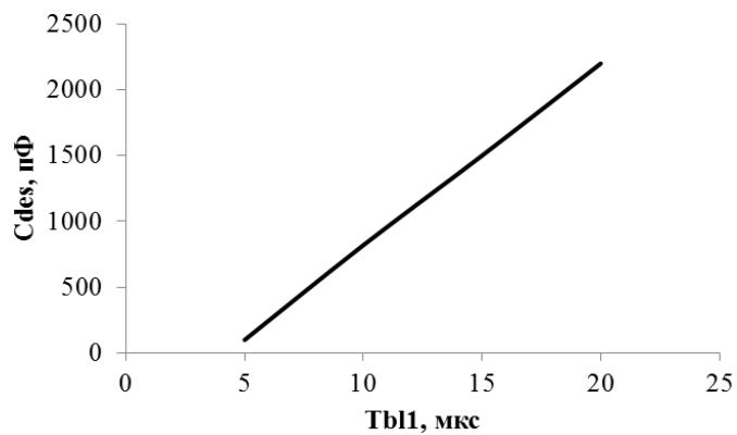
Рисунок 8 – График зависимости длительности задержки включения защиты по насыщению от номинала ёмкости  $C_{des}$
