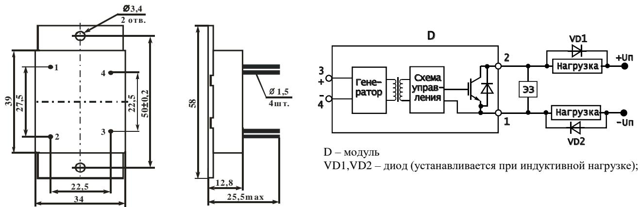
Неуказанные предельные отклонения присоединительных размеров  $\pm 0,5$  мм
