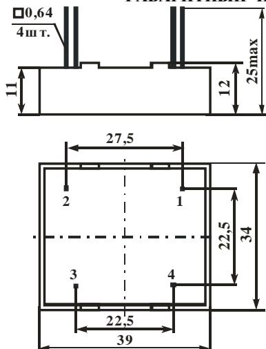
Неуказанные предельные отклонения присоединительных размеров  $\pm 0,5$  мм
