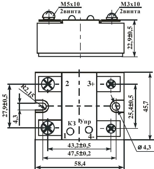
Неуказанные предельные отклонения присоединительных размеров  $\pm 0,5$  мм
