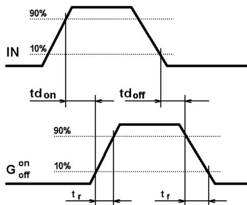
где IN – входной сигнал управления; G – сигнал на затворе управляемого транзистора
