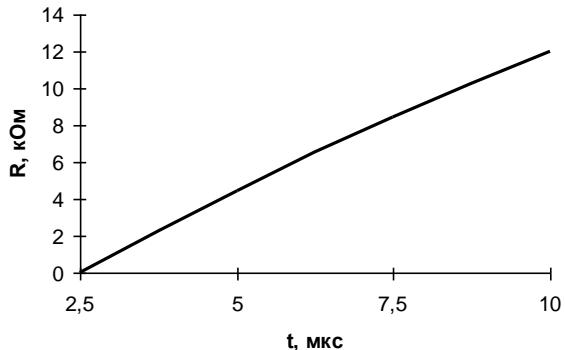
Рисунок 11 – График зависимости длительности задержки на переключение от номинала подстроечных резисторов
