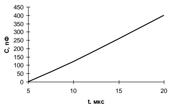
Рисунок 10 – График зависимости длительности задержки включения защиты по насыщению от подстроекной ёмкости
