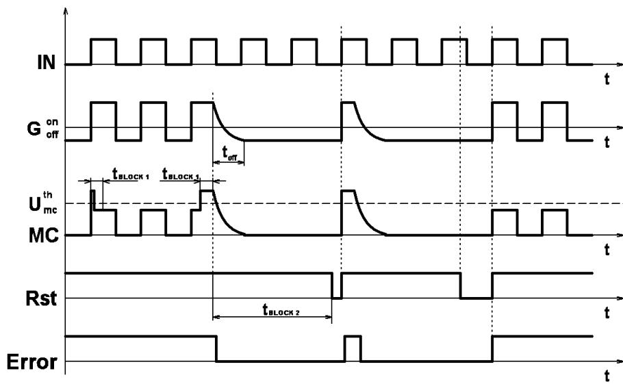
где IN – входной сигнал, G – сигнал на затворе управляемого транзистора,
