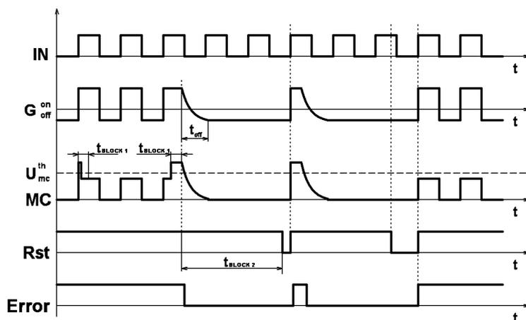
где IN – входной сигнал;  $G_{off}^{on}$  – сигнал на затворе; Rst – периодический внутренний сигнал сброса; MC – сигнал на измерительном коллекторе; Error – статусный выход
