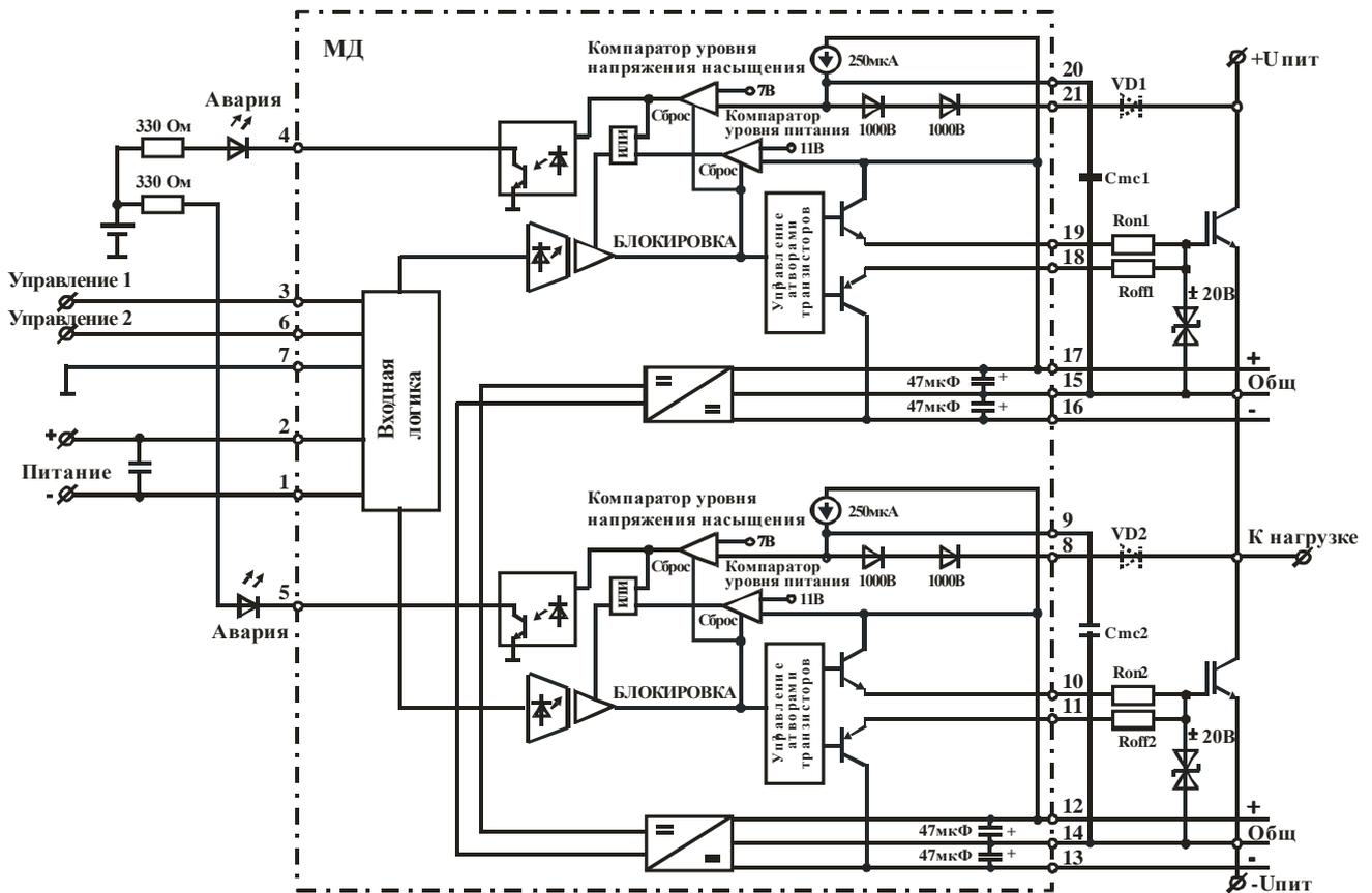
Рисунок 2– Функциональная схема и схема включения драйвера
