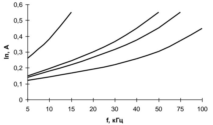
Рисунок 6 – График зависимости тока потребления от частоты сигнала под нагрузкой (с затворным резистором 1 Ом)
