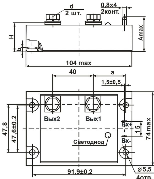
Неуказанные предельные отклонения присоединительных размеров  $\pm 0,5$  мм
