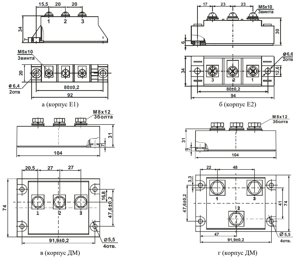
Неуказанные предельные отклонения присоединительных размеров  $\pm 0,5$  мм
