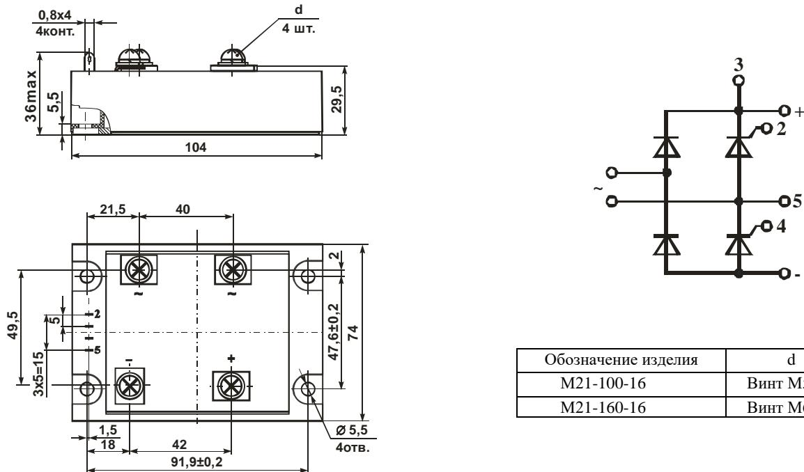
Неуказанные предельные отклонения присоединительных размеров  $\pm 0,5$  мм
