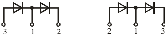
Рисунок 2 – Схема соединения модулей типа M4 – для токов 25 А ÷ 160 А и типа M4A – для токов 200 А ÷ 250 А
