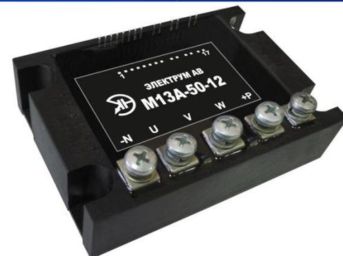
Интеллектуальный инвертор серии **M31** предназначен для коммутации нагрузки в соответствии с логическими сигналами управления ключами инвертора.
