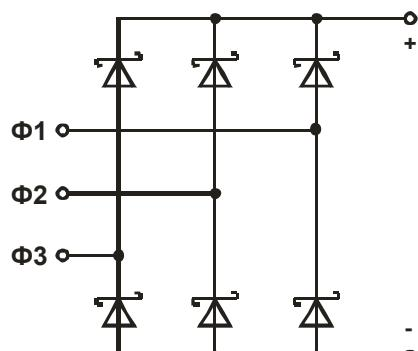
Рисунок 1 – Схема соединения модуля
