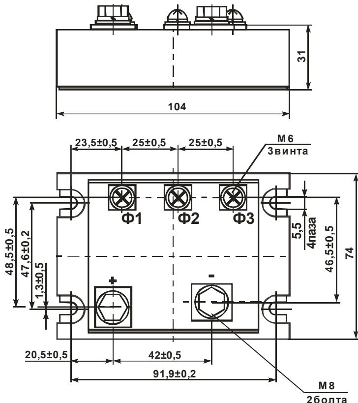
Рисунок 2 – Габаритные и присоединительные размеры модуля
