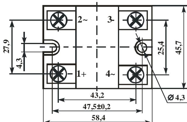
Неуказанные предельные отклонения присоединительных размеров  $\pm 0,5$  мм
