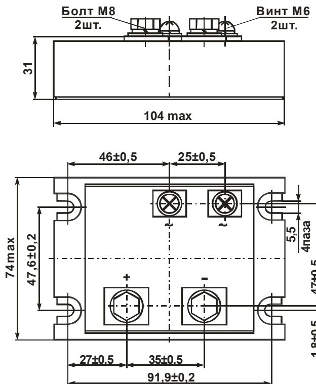
Рисунок 2 – Габаритные и присоединительные размеры модуля
