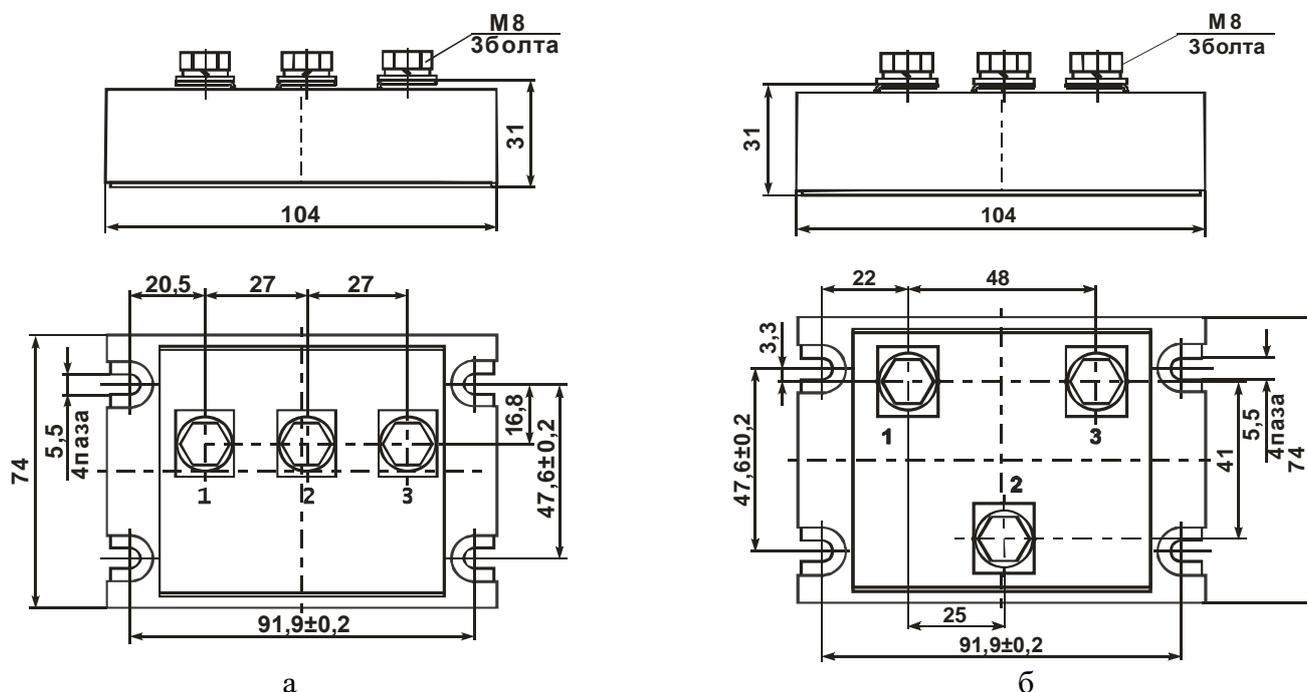
Неуказанные предельные отклонения присоединительных размеров  $\pm 0,5$  мм
