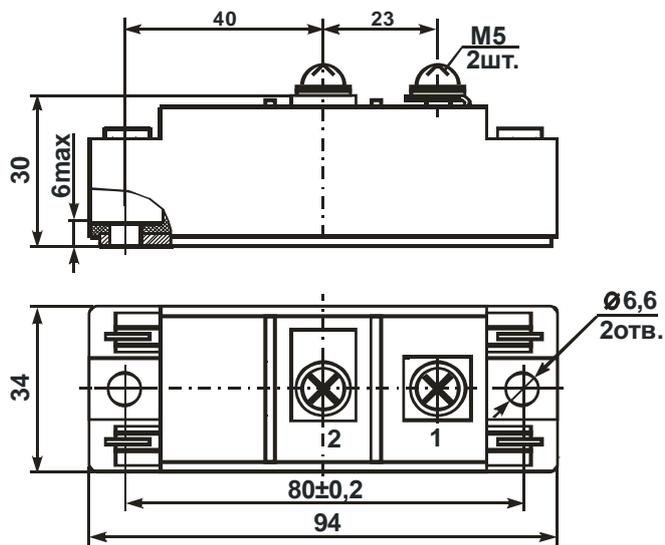
Неуказанные предельные отклонения присоединительных размеров  $\pm 0,5$  мм
