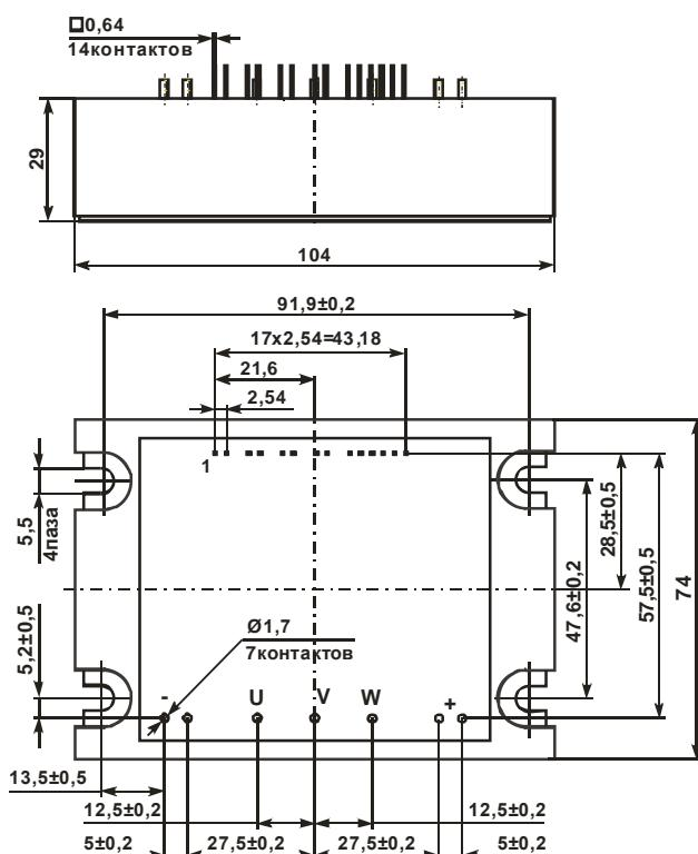
Минимальная высота контактов над корпусом 8 мм
