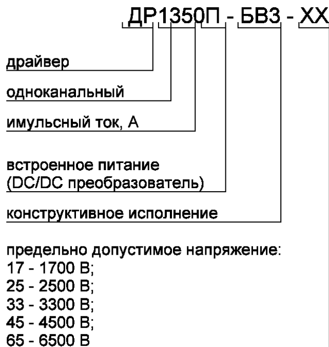
Рисунок 1 – Структура обозначения драйвера
