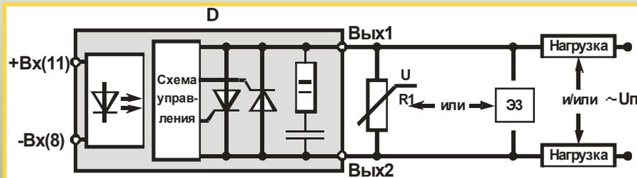
**РЕЛЕ ТИРИСТОРНОЕ ОДНОФАЗНОЕ**
