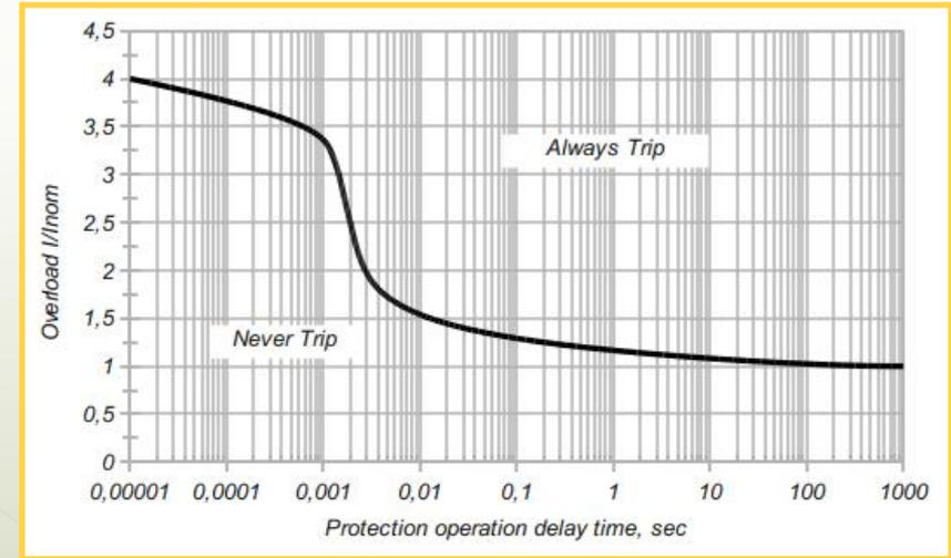
Модули МККТ так же являются реле постоянного тока, но в отличие от всех вышеуказанных реле, имеют интеллектуальную схему защиты по току с нелинейной характеристикой и критерием защиты  $I^2t$ .
